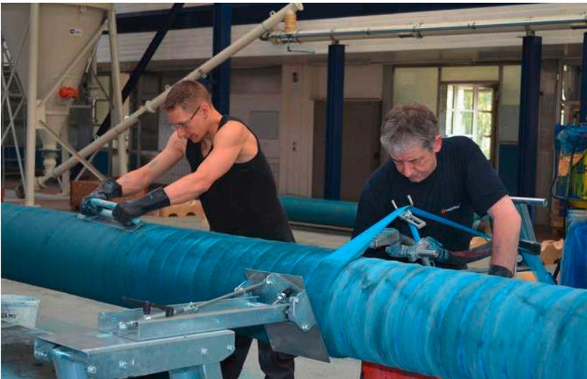
Auftragen der Faserzementmörtelumhüllung (FZM) auf der Beschichtungsanlage.
